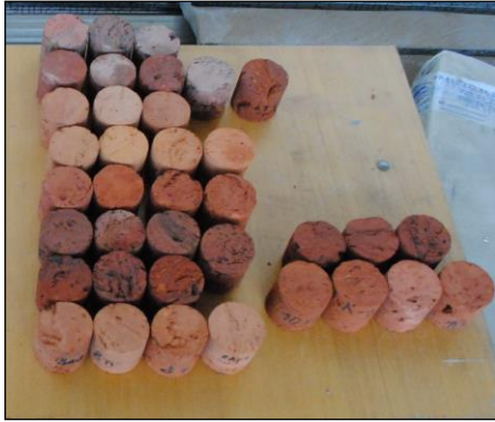
Рисунок 2. Керны, отобранные из свода
