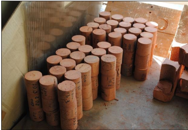
Рисунок 6. Часть выбуренных образцов-кернов
