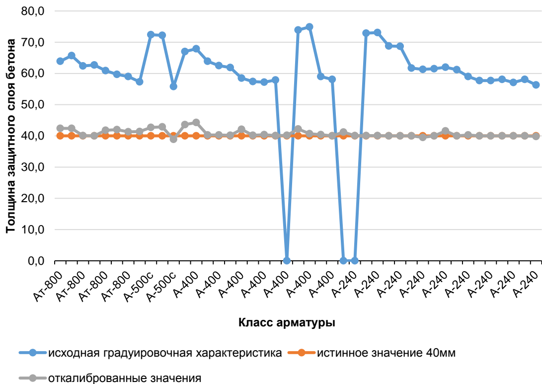
Рисунок 2. Значения испытаний для толщины защитного слоя бетона 40 мм
