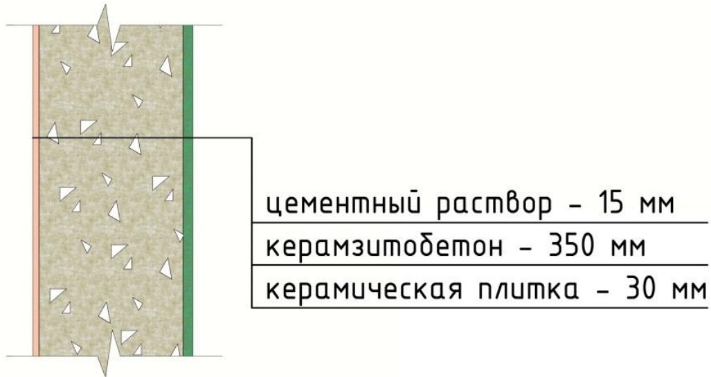
Рисунок 2 – Однослойная бетонная панель наружных стен зданий серии 137
