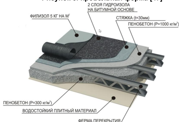
Рисунок 6. Плоская кровля [47]
