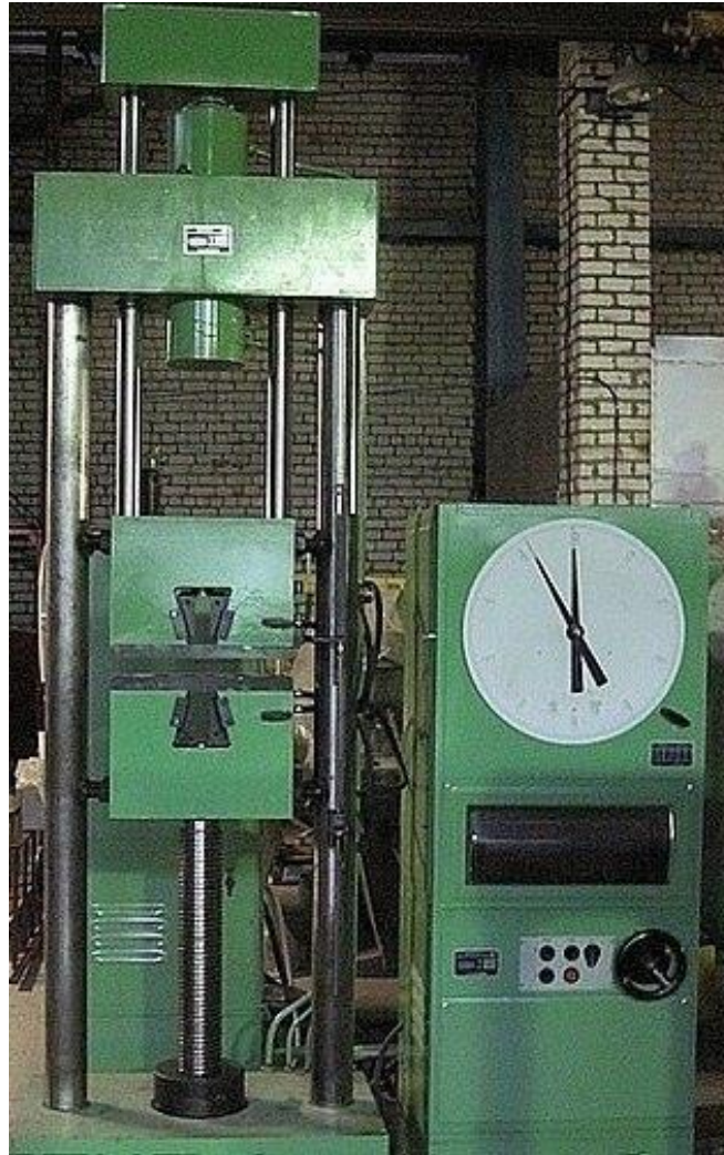
Рисунок 2. Вид экспериментальной установки. Гидравлический пресс П-500
