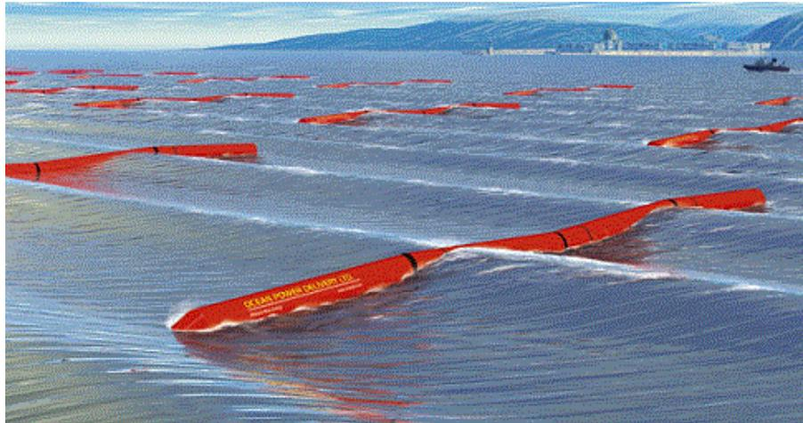
**Рис.3 Преобразователь с подвижными элементами**
