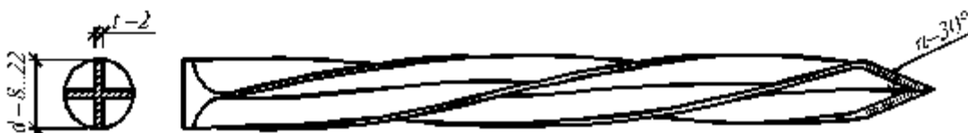
Рисунок 3. Стальной крестообразный стержень, витой формы
