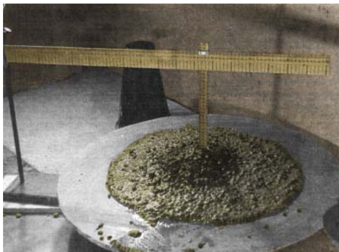
Рисунок 1. Влияние воздухововлекающей ЛХД в комплексе с суперпластификатором С-3=0,8% на характер пластификации бетонной смеси с расходом цемента 400 кг/м 3 С-3=0,8%+ЛХД=0,05% ОК=23 см; D=57 см
