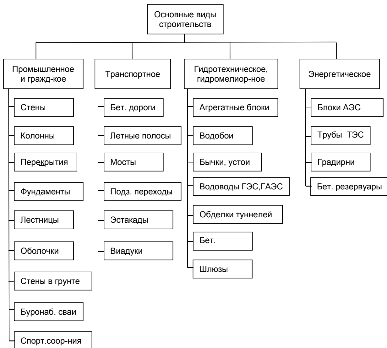
Рисунок 3. Блок-схема применимости литых бетонных смесей по видам строительства, сооружений и конструкций
