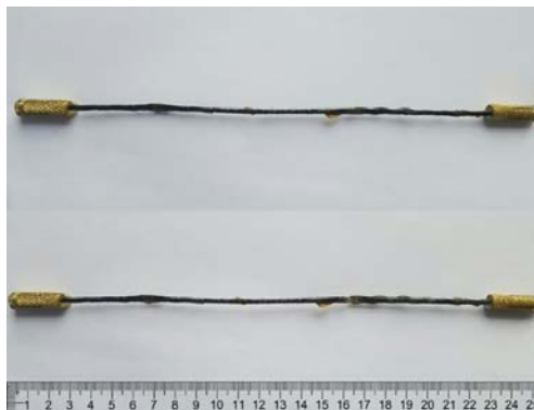
Рисунок 3. Образец элемента базальтопластиковой сетки до и после испытания
