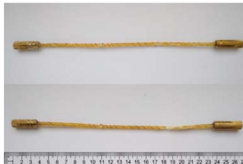
Рисунок 2. Образец элемента стеклопластиковой сетки до и после испытания
