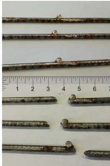
Рисунок 1. Образцы элементов стальной сетки до и после испытания
