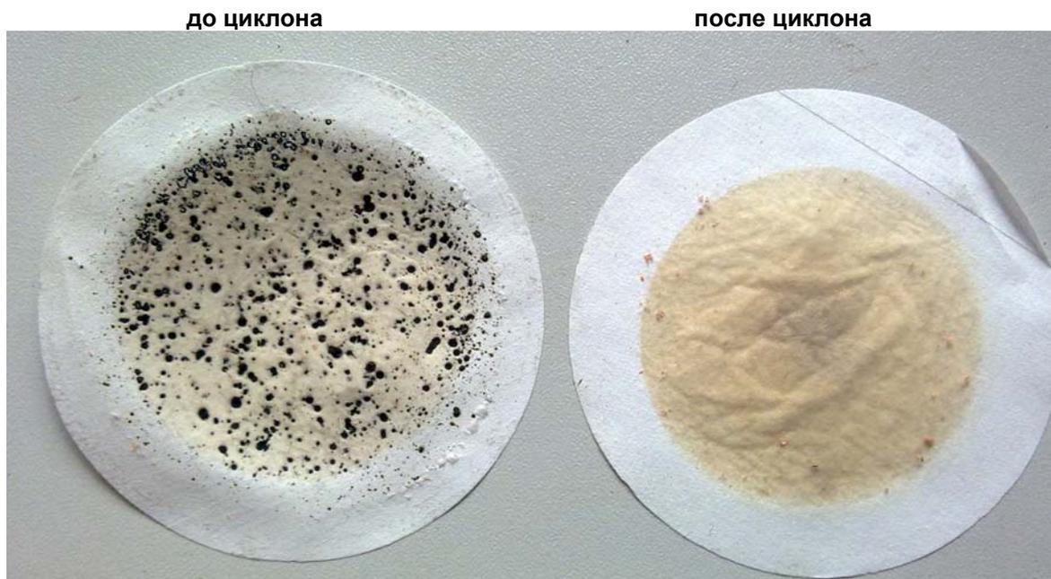
Рисунок 7. Состояние маркеров перед циклоном и после циклона
