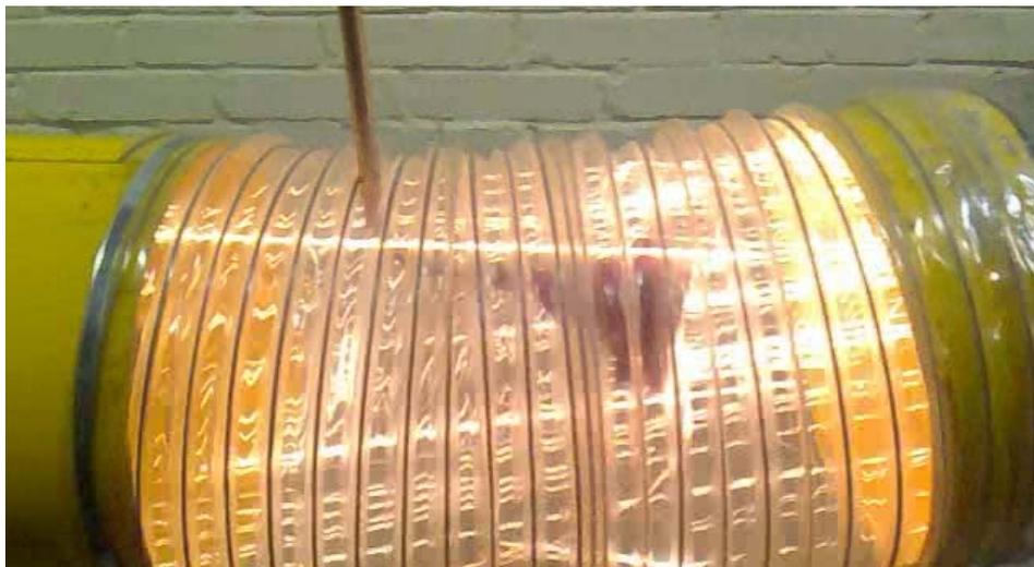
**Рисунок 4. Трассы раскаленных капель на входе в циклон. Расстояние до сварочной дуги 2 метра. В центре воздуховода расположен маркер - аллонж пылеприемник [26]**
