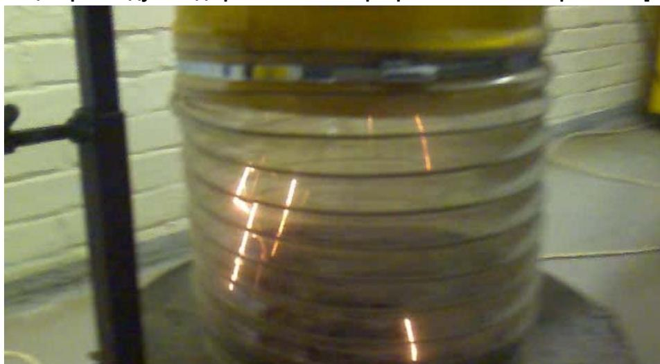
**Рисунок 5. Единичные трассы раскаленных твердых капель на выходе из циклона в пылесборник.**
