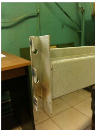
Рис. 2 Соединение гребенчатый зацеп (узел балка-стойка, стяжка-стойка)
