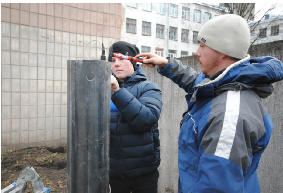
Рисунок 4. Возбуждение упругой волны в исследуемой свае
