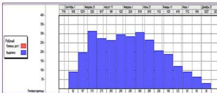
Рис 5. Неоптимизированный график движения рабочих(1 вар.)
