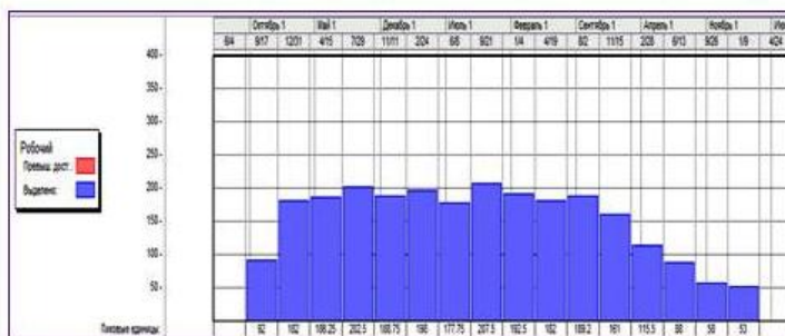
Рисунок 7 Результаты расчета по снижению пиковых значений графика движения рабочих
