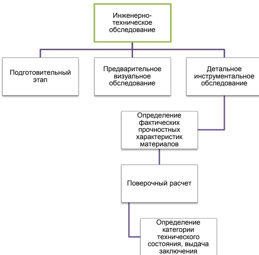
Рисунок 1. Этапы инженерно-технического обследования
