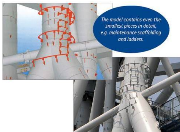
Рис. 10 Модель телебашни в программе Tekla Structures
