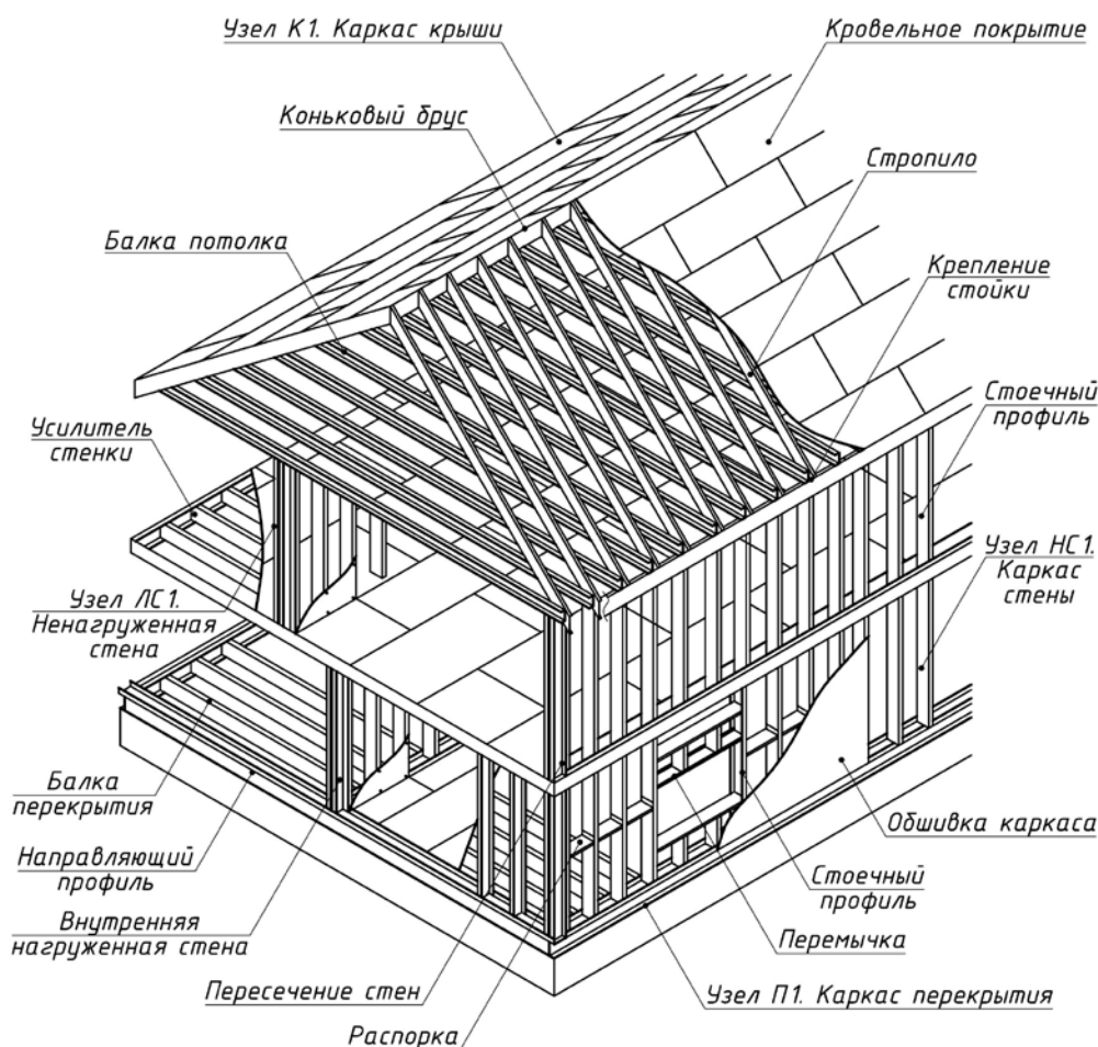
Рисунок 7. Принципиальная схема устройства здания на основе каркаса из ЛСТК
