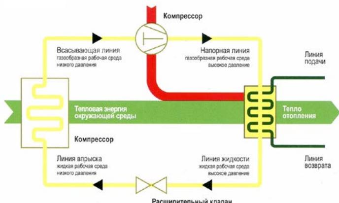
Рисунок 1. Принцип работы теплового насоса [20].
