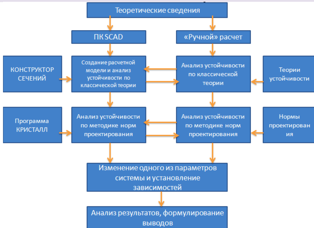
Рисунок 2. Схема выполнения виртуальной лабораторной работы «Анализ устойчивости центрально-сжатой стойки сквозного сечения»
