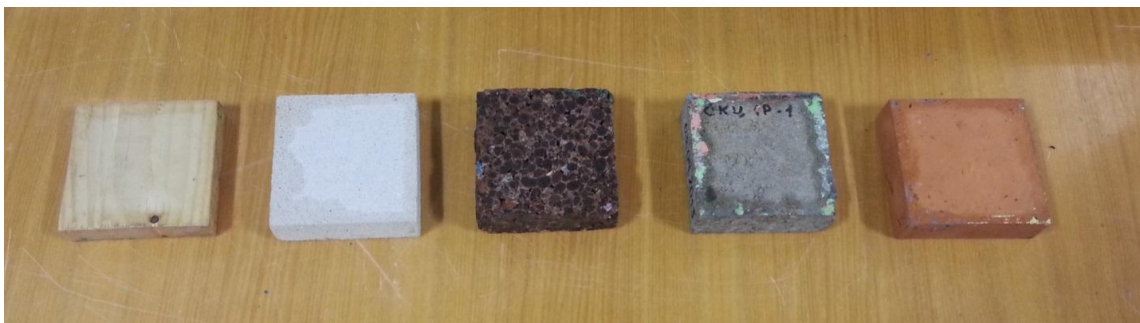
Рисунок 1. Образцы испытываемых материалов (слева направо): дерево (сосна), газобетон автоклавного твердения марки D600, камень полнотелый стеновой керамзитобетонный марки КСКЦ 40-20-19-50/950, камень стеновой бетонный марки СКЦ 1Р-1, глиняный обожженный полнотелый кирпич
