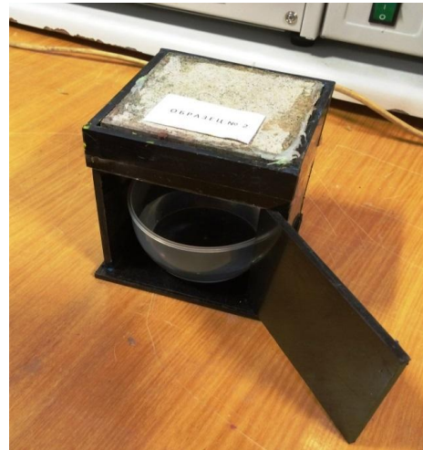
Рисунок 3. Образец стенового бетонного камня марки СКЦ 1Р-1, изъятый из шкафа для взвешивания при испытании.
