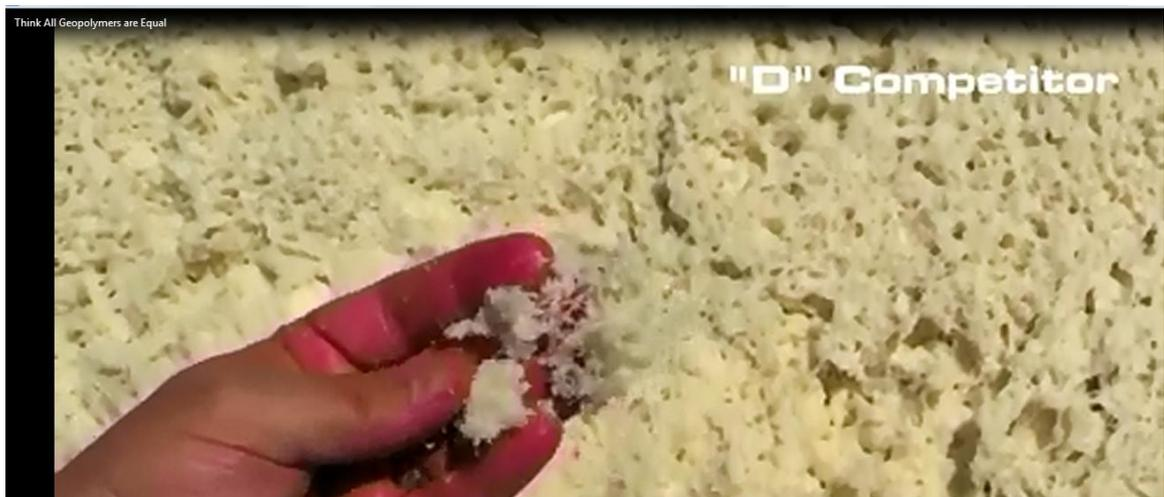
Рисунок 16. Прочий пенополиуретан структурно нестабилен и обладает гидрофобными свойствами.
