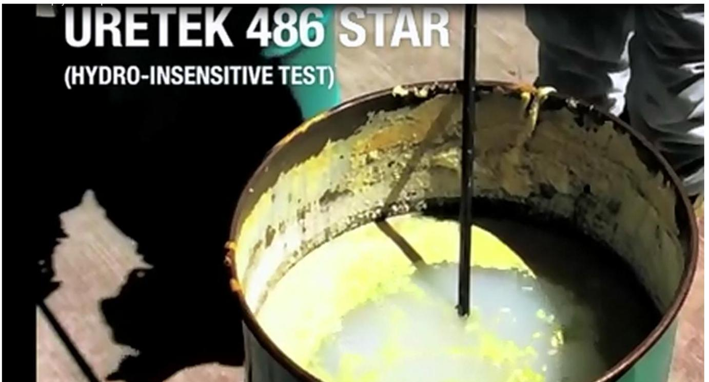
Рисунок 12. Инъектирование материала Uretek в воду
