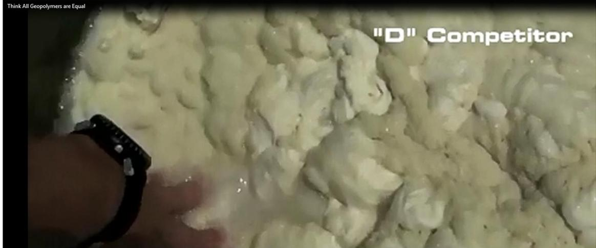
Рисунок 15. Прочий материал продолжает вспениваться при взаимодействии с водой. Гомогенная структура не образуется. При нажатии через поверхность пены проходит вода.
