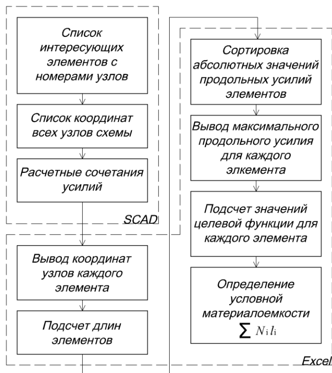
Рисунок 7. Схема алгоритма определения условной металлоемкости
