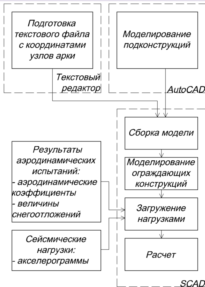
Рисунок 3. Схема алгоритма создания расчетной модели
