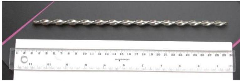
Рисунок 9 – Винтовой стержень
