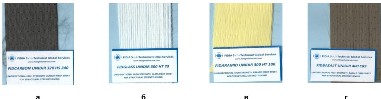
Рисунок 3. Образцы композитных материалов (а – углеволокно; б – стекловолокно; в – арамидволокно; г – базальтовое волокно)
