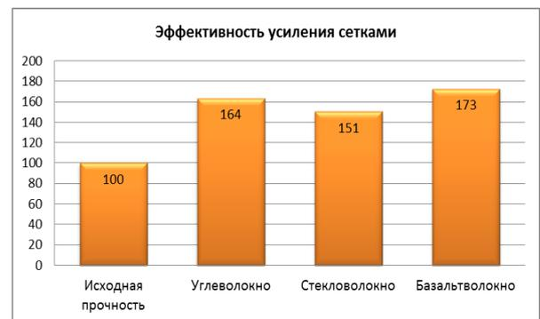
Рисунок 8 (а - сравнение технологической эффективности усиления лентами, б – сетками)
