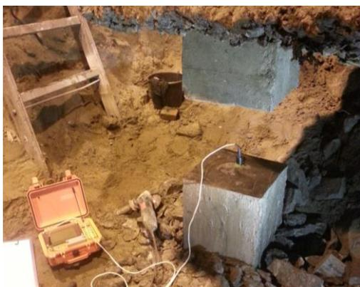
Рисунок 5. Установка прибора ИДС-1 на оголовке сваи
