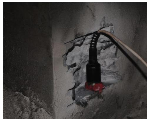
Рисунок 6. Способ установки датчика в штрабе на поверхности сваи
