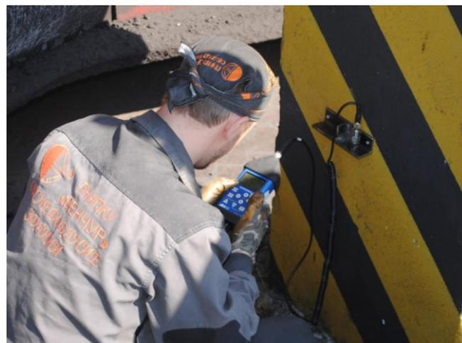
Рисунок 18. Измерения виброметром Алгоритм-03-001РЭ (SvanteK)
