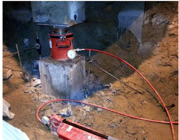
Рисунок 13. Установка оборудования для испытания сваи в осях 19/Д
