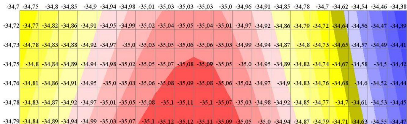
Рисунок 7. Изополя перемещений и их значения в узлах опоры №1 акведука в SCAD
