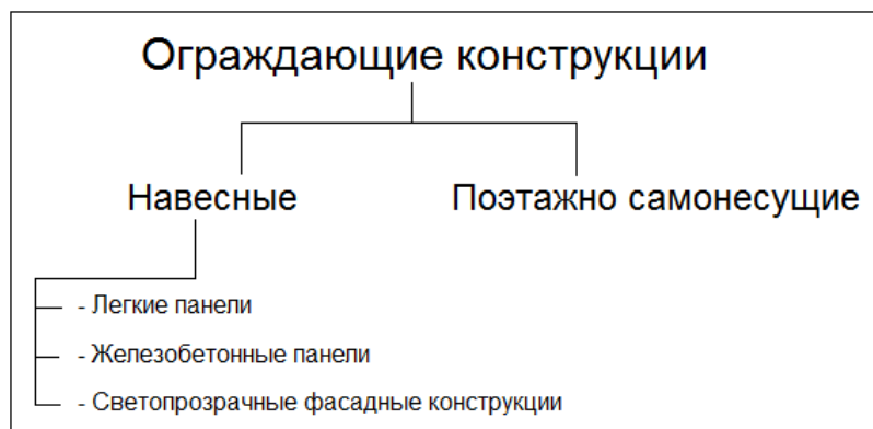
Рисунок 1: Виды ограждающих конструкций
