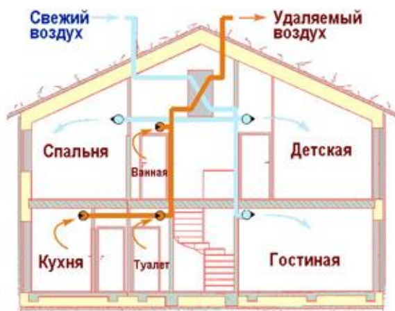
Рисунок 3. Принцип работы правильной вентиляции [36]
