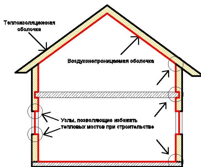
Рисунок 5. Схема непрерывной теплоизоляционной оболочки здания
