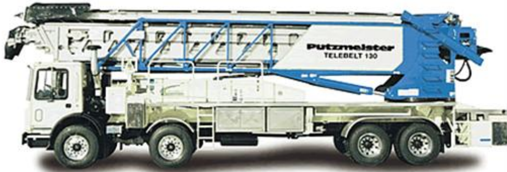
Рисунок 3. Мобильный 5-ти секционный телескопический ленточный транспортер фирмы “Путцмайстер” – ТВ 39/130 (Telebelt)
