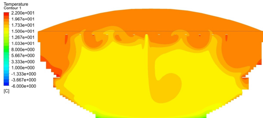
Рисунок 29. Поле распределения температуры в скорректированном варианте организации воздухообмена
