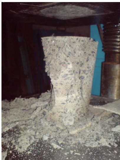
Рисунок 3. Внешний вид и характер разрушения контрольных образцов-цилиндров: а – образец № 9ст; б – образец № 7п
