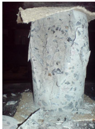
Рисунок 3. Внешний вид и характер разрушения контрольных образцов-цилиндров: а – образец № 9ст; б – образец № 7п
