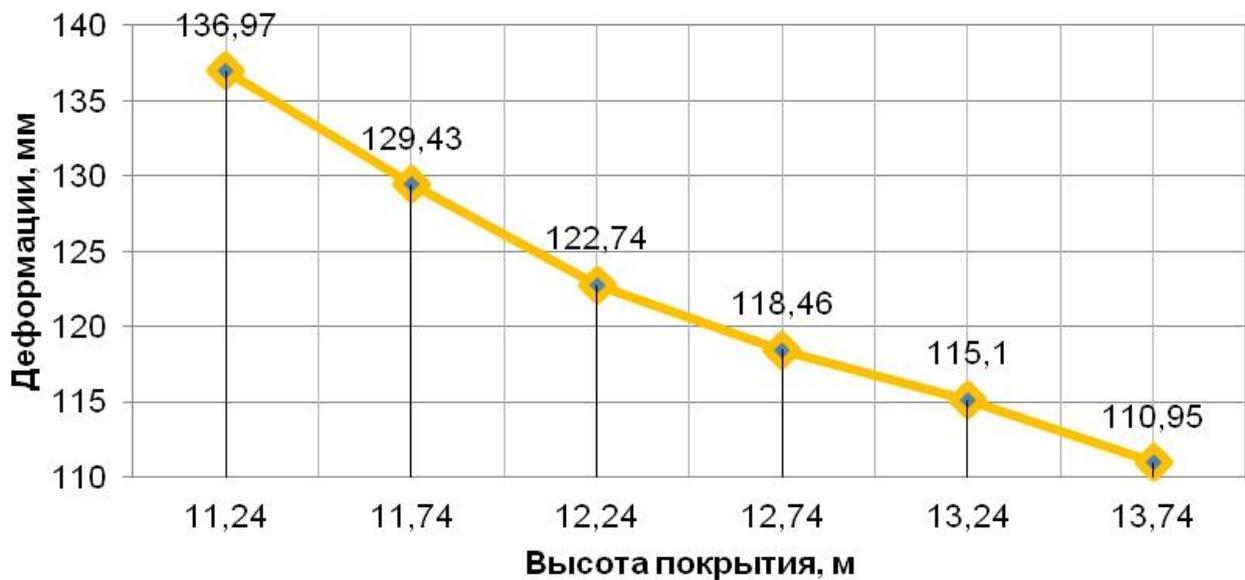
Рисунок 22. График зависимости прогиба покрытия перекрестных ферм от ее высоты
