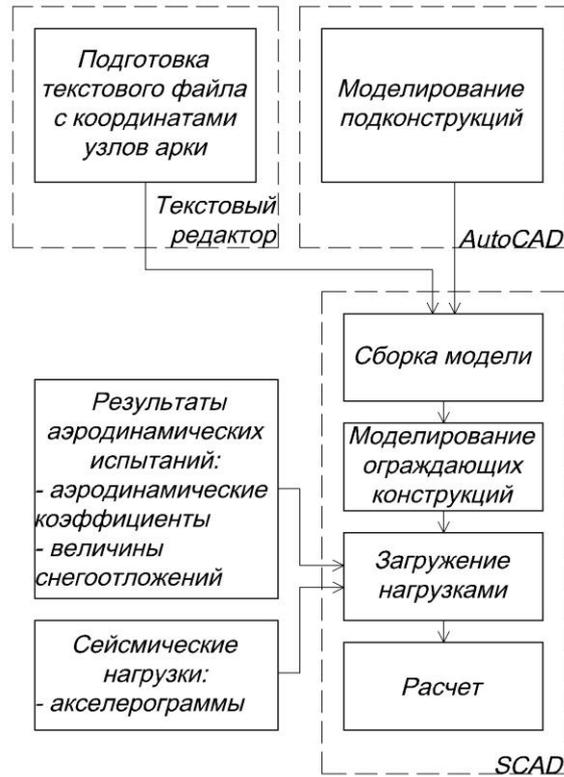
Рисунок 7. Алгоритм создания расчетной модели
