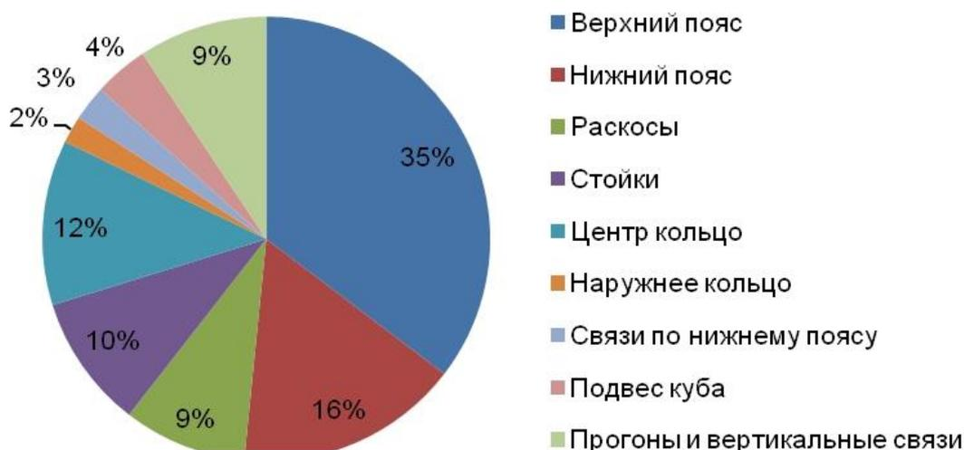
Рисунок 16. Массовая доля конструктивных элементов покрытия с радиальными фермами
