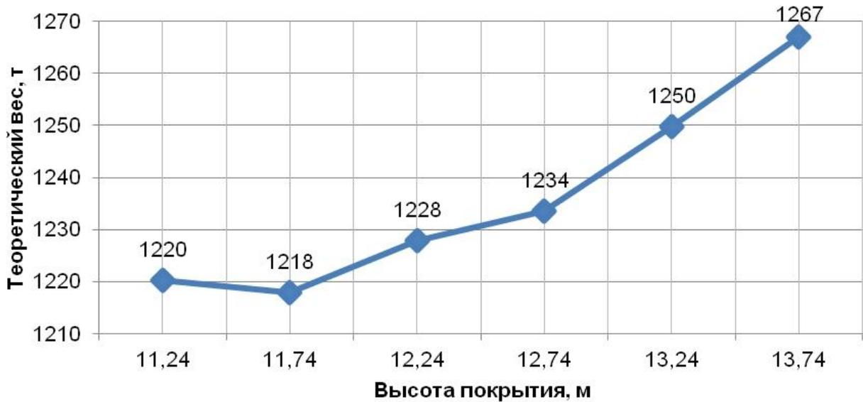
Рисунок 21. График зависимости металлоемкости покрытия перекрестных ферм от ее высоты
