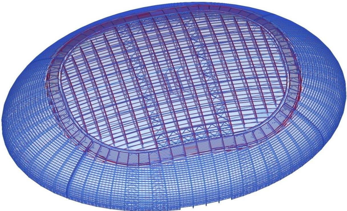
Рисунок 8. Конечно-элементная модель расчетной схемы в ПК SCAD
