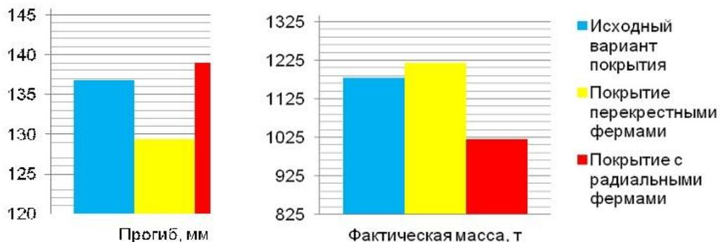
Рисунок 24. Сравнение вариантов покрытия по металлоемкости и прогибу
