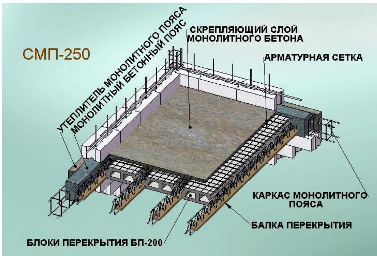
Рисунок 1 Общая конструктивная схема сборно-монолитного перекрытия «МАРКО» [1]
