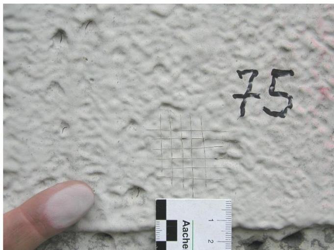
**Рисунок 3. Меление поверхности эпоксидного покрытия вследствие процесса фотокаталитической деградации материала.**
