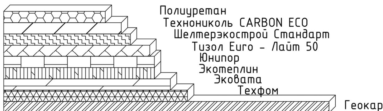
Рисунок 2. Сравнение толщины различных утеплителей
