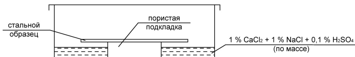
Рис.2. Схема испытания тонкостенных стальных изделий на коррозию в условиях контакта с пористым материалом (утеплителем)
