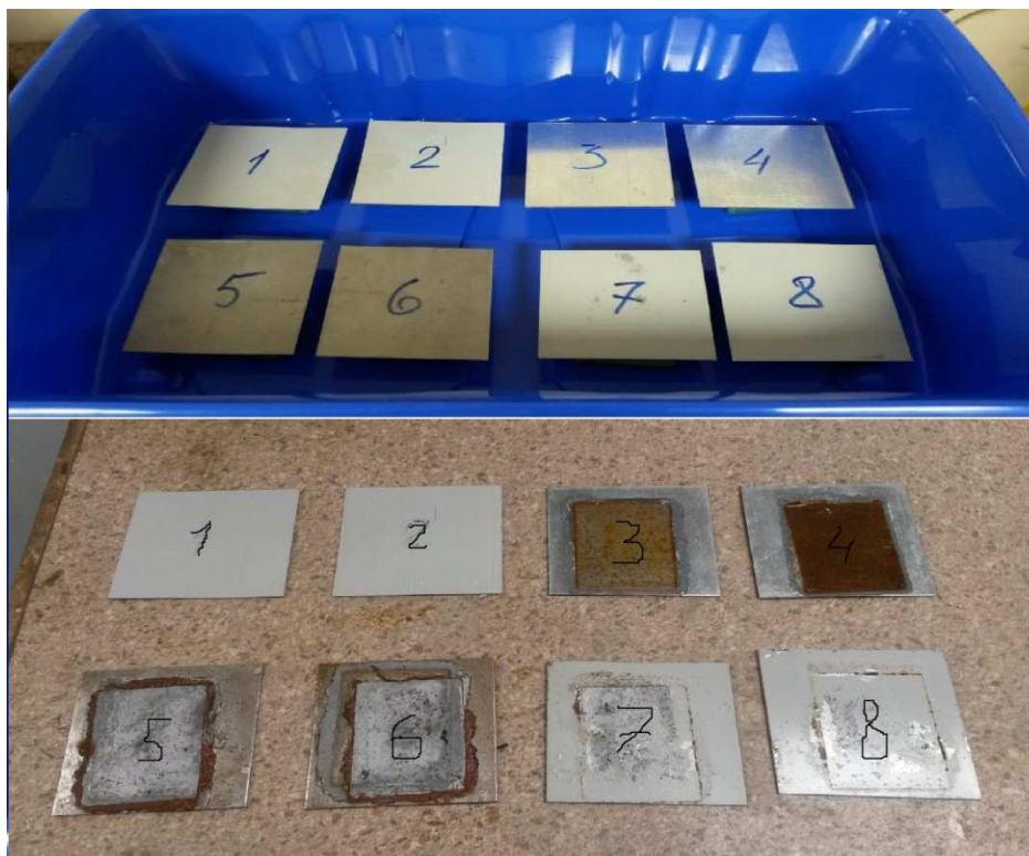
Рис.3. Предварительные результаты испытания стальных образцов на коррозию. Виды покрытия стальных образцов: 1,2 – оцинковка с дополнительным лакокрасочным покрытием; 3,4 – оцинковка; 5,6 – без покрытия; 7,8 – лакокрасочное покрытие.
