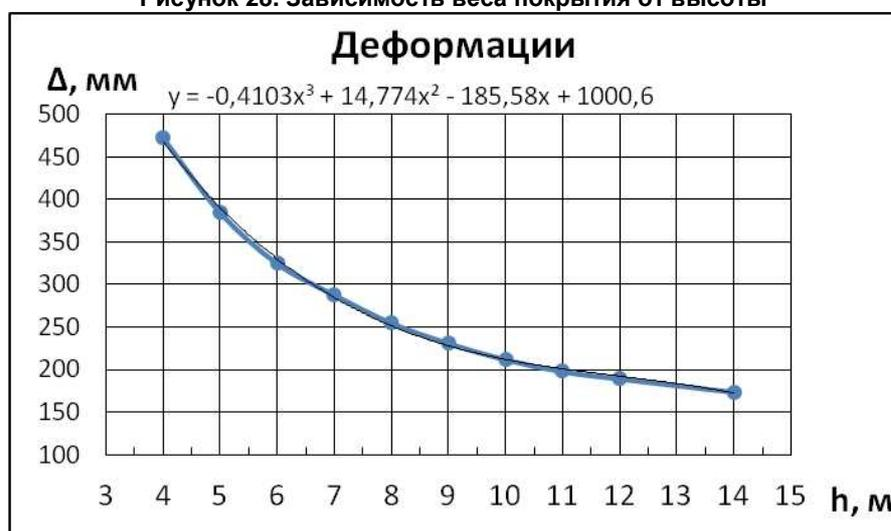
Рисунок 29. Зависимость максимальных вертикальных деформаций от высоты
