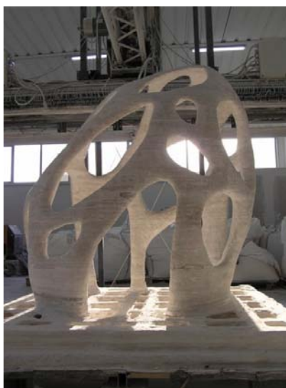
Рисунок 3. Скульптура “Радиолярия”, изготовленная по технологии D-Shape
