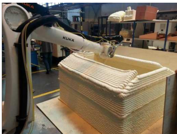
Рисунок 8. Процесс печати дома принтером INNOprint [6]
