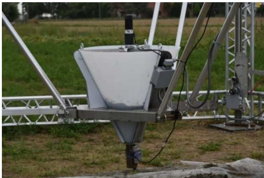
Рисунок 3. Вращающееся сопло 3D-принтера Big Delta [6]
