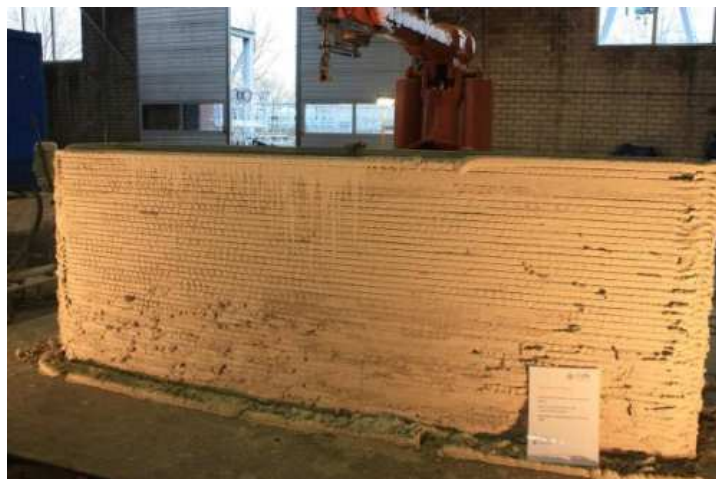
Рисунок 5. Процесс работы принтера-манипулятора ProTo R 3DP
