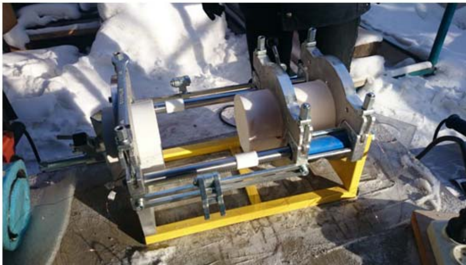
Рис. 3. Свободное охлаждение муфты и трубы для выравнивания температур (2 минуты)
