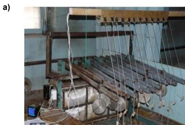
Рис. 9. Стенд для испытаний на длительное растяжение: а) Общий вид; б) Схема стенда
