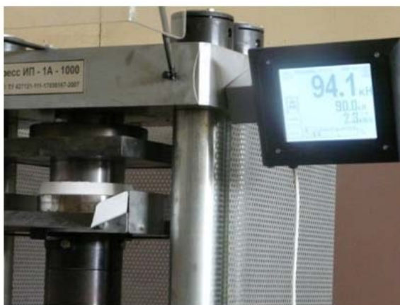
Рис. 8. Испытание раструбного сварного соединения на сдвиг сжатием на машине ИП-1А-1000
