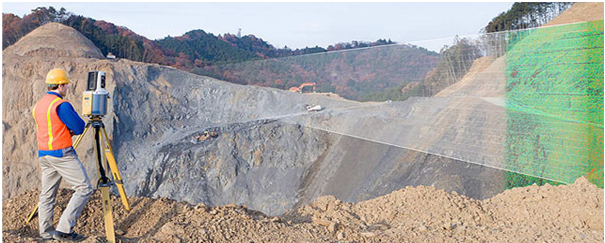
Рисунок 4. Принцип наземного лазерного сканирования [37]
