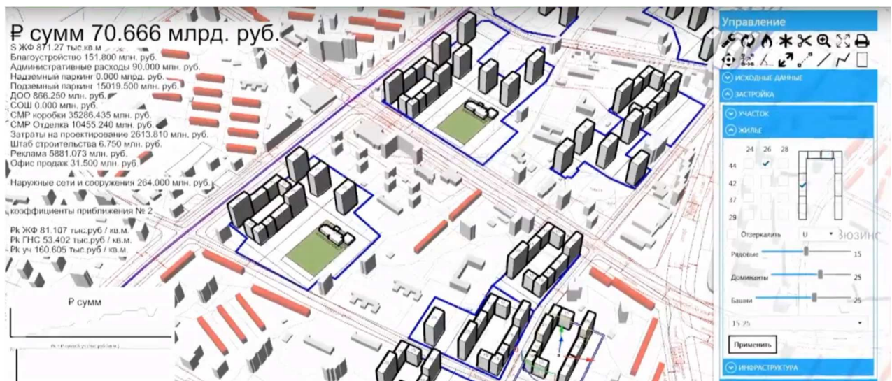
Рисунок 5. Генерация вариантов застройки участка и подсчёт ТЭП с помощью Робота R1 (разработка ООО «ПИК-Проект») [38]
