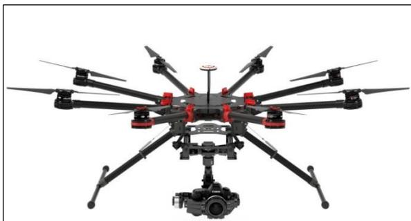
Рисунок 1. БПЛА мультироторного типа DJI S1000
