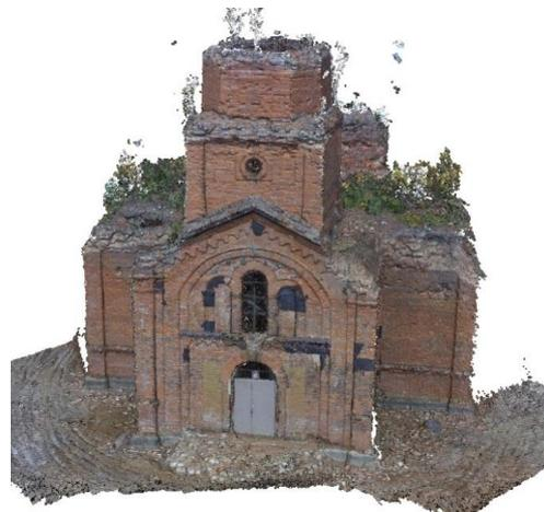
Рисунок 16. Плотное облако точек формирует очертания трехмерной модели
