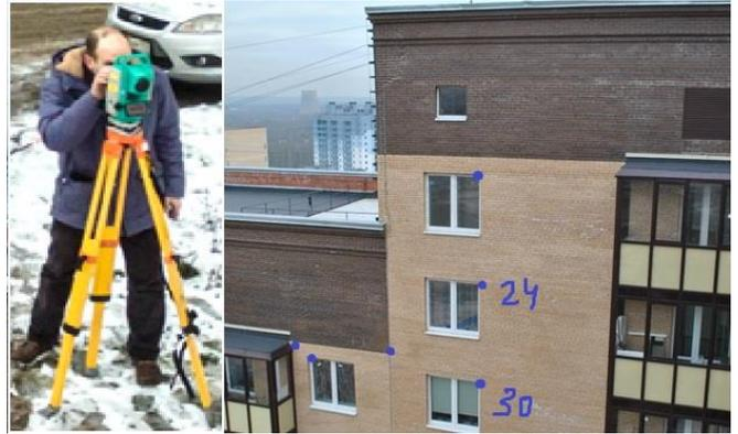
Рисунок 4. Геодезическая съемка фасада
