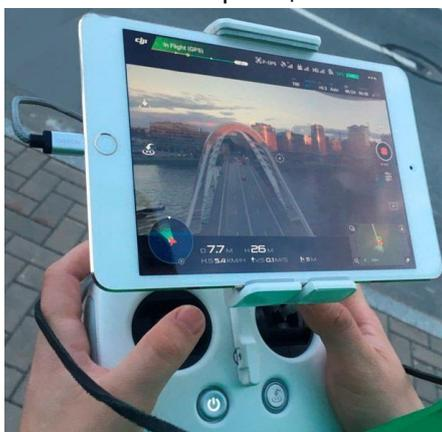
Рисунок 8. Экран для приема видеосигнала
