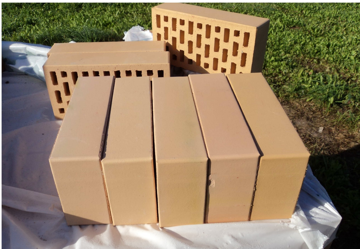
Рисунок 11. Пустотелый кирпич с щелевидными пустотами
