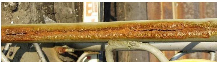
**Рисунок 10. Трещины в трубах поясов по сварному шву**
