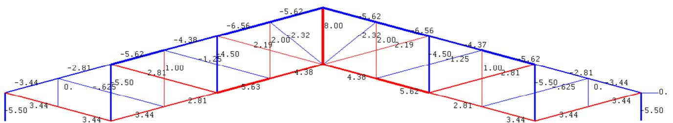
Рисунок 6. Усилия в стержнях при  $n=4$
