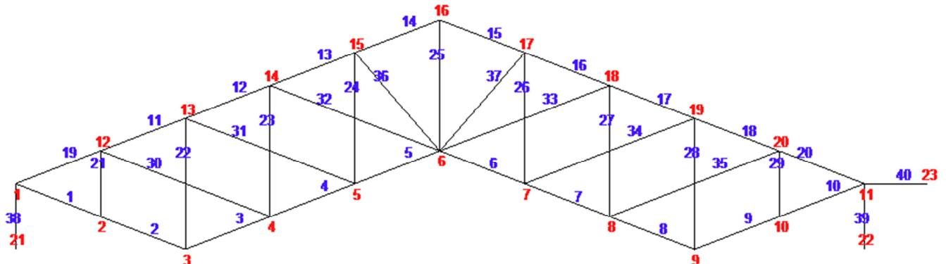
Рисунок 2. Нумерация узлов и стержней в системе Maple [10],  $n=3$
