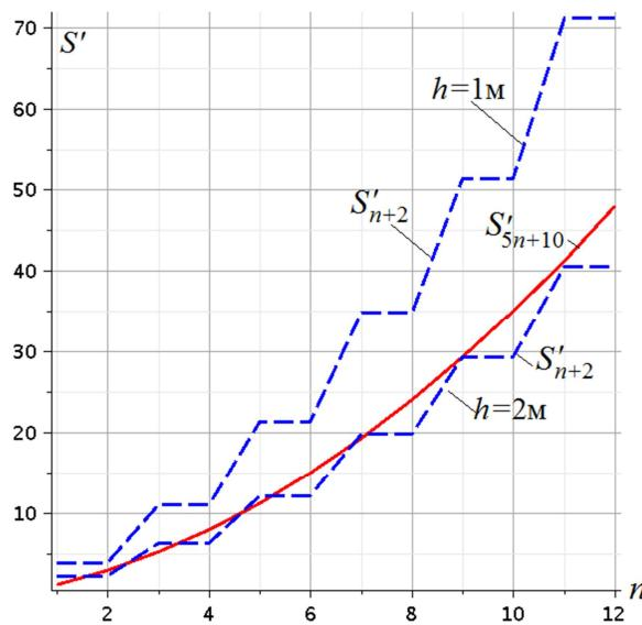
Рисунок 7. Перераспределение усилий в наиболее растянутых стержнях
