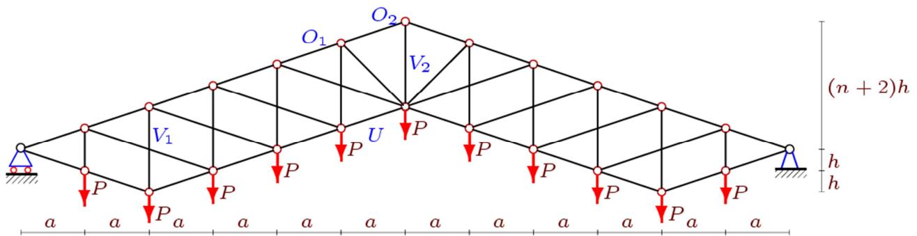
Рисунок 8. Нагрузка по узлам нижнего пояса,  $n=4$
