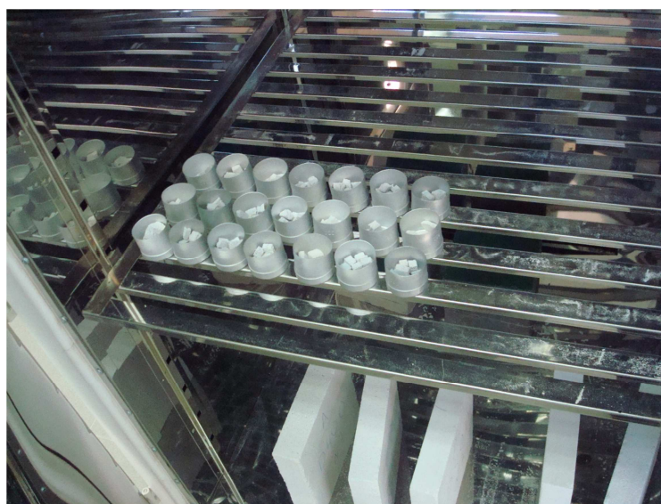
Рисунок 6. Высушивание образцов ячеистого бетона при проведении испытаний по ГОСТ 24816 [45]
