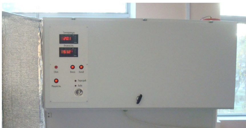
Рисунок 10. Температура и относительная влажность воздуха в теплом отсеке климатической установки
