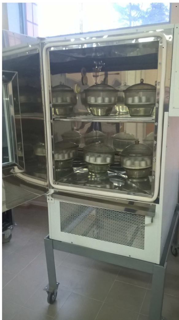
Рисунок 7. Установка эксикаторов в климатическую камеру
