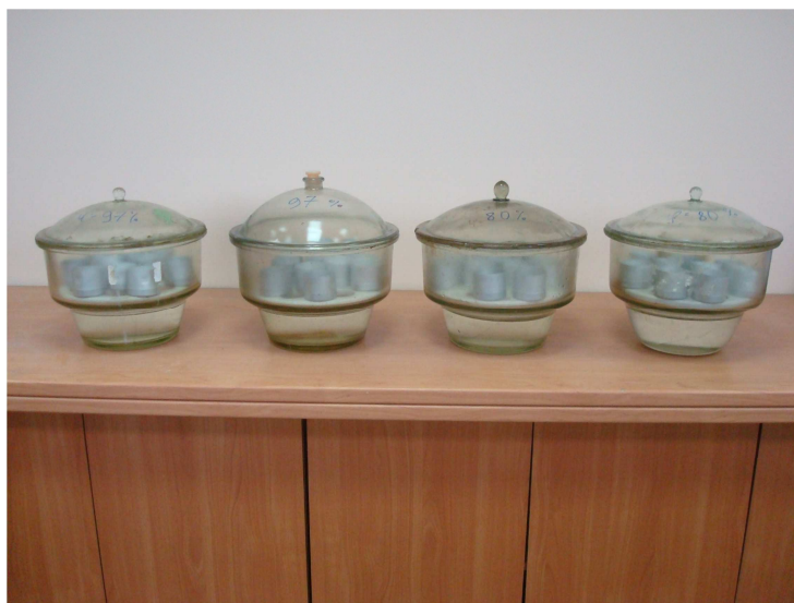
Рисунок 5. Эксикаторный метод определения сорбционной влажности образцов ячеистого бетона
