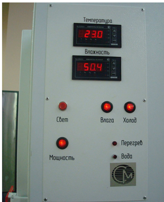
Рисунок 15. Поддержание заданных значений температуры и относительной влажности в испытательной камере
