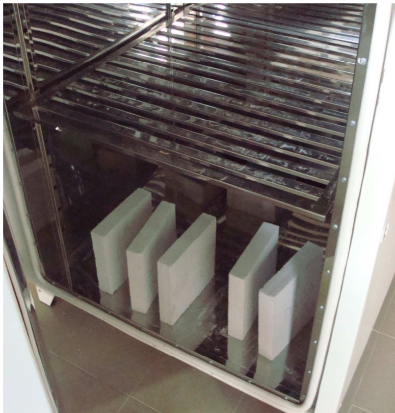
Рисунок 4. Высушивание образцов до постоянной массы в сушильном шкафу
