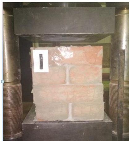
Рисунок 1. Модель образцов № 1 (неармированный кирпичный столб)
