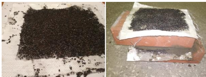
Рисунок 9. Применение опесчанной стеклоткани для повышения прочности сцепления
