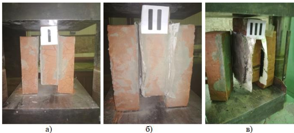
Рисунок 12. Характер разрушения образцов: а) образец с неармированными растворными швами; б) образец с растворными швами, армированными стеклотканым материалом; в) образец с растворными швами, армированными опесчаненным стеклотканым материалом
