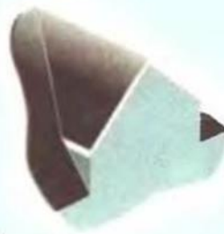
Слуховое окно с боковыми стенами и фронтоном вне плоскости фасада
