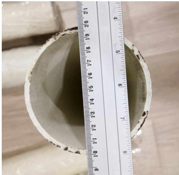
Рис. 5. Сечение стеклопластикового основания сваи.
