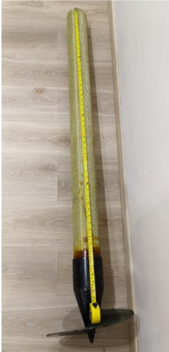
Рис. 3. Конструкция композитной винтовой сваи
