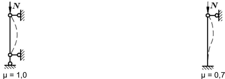
Лопасть, превышающая в 4 раза диаметр основания сваи и наиболее вероятно не позволяющая поворот, обеспечивает жесткую заделку. Тем не менее, для расчета на данном этапе в запас примем шарнир и коэффициент расчетной длины  $\mu = 1,0$ .
