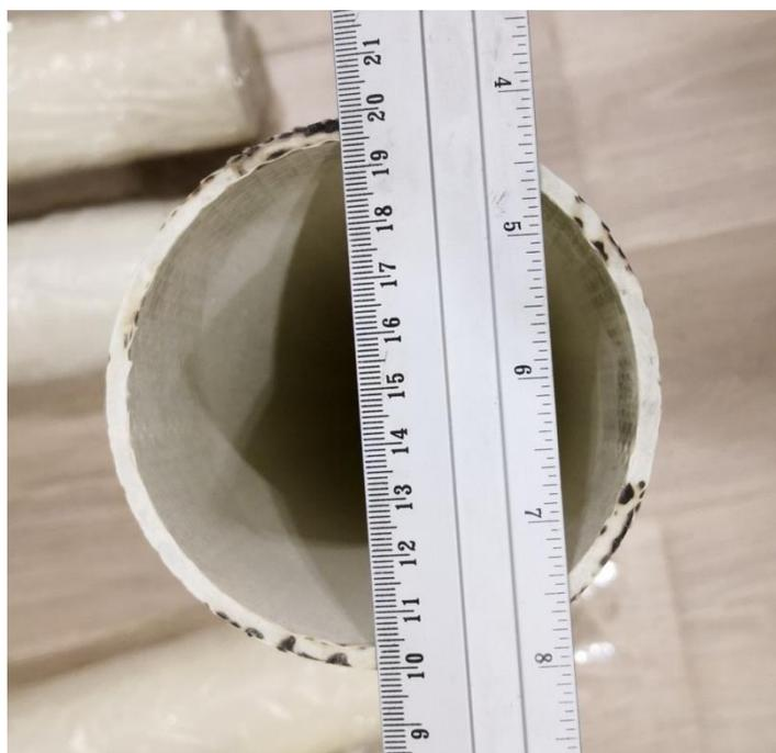
Рис. 5. Сечение стеклопластикового основания сваи.
