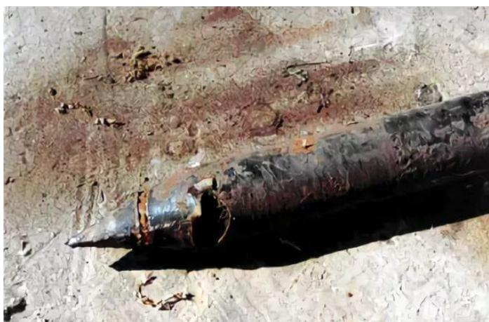
Рис. 2. Срез винтовой лопасти.
