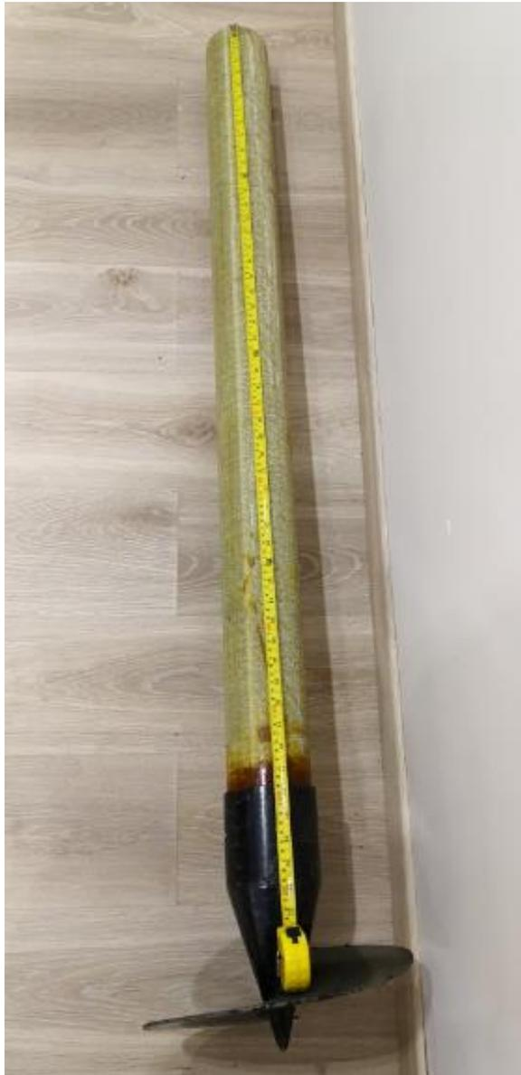
Рис. 3. Конструкция композитной винтовой сваи
