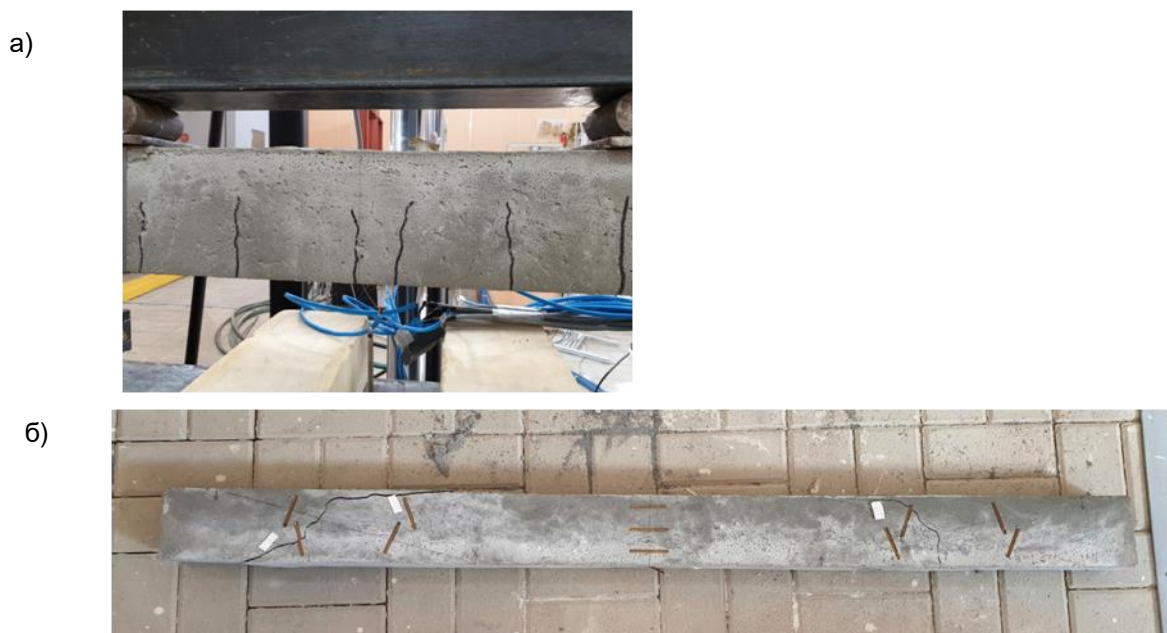
Рис. 6 - Характер трещинообразования пенобетонных перемычек в стадии разрушения при испытании на изгиб: а) с неполным каркасом; б) с полным каркасом
