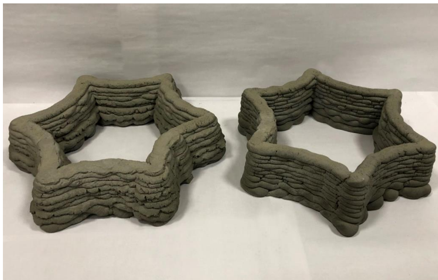
Рис. 1 – Напечатанные на 3D-принтере образцы из цементно-песчаного раствора криволинейной формы с дефектами и повреждениями
