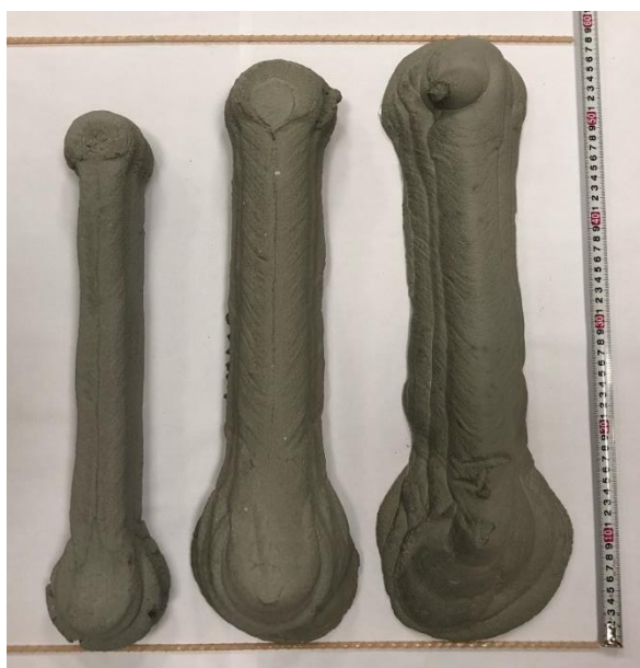
Рис. 3 – Затвердевшие композиты, напечатанные на 3D-принтере (вид сверху): слева направо – Пк 2, Пк 3, Пк 4
