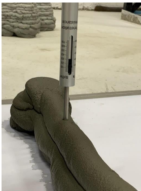
Рис. 2 – Определение кинетики набора прочности растворной смеси во времени с помощью карманного пенетromетра
